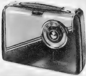
Eine eingebaute Ferrit-Stubantenne befreit von Antennensorgen und der Hochleistungs-lautsprecher ergibt gute Wiedergabe. Das Gehäuse zeigt eine flotte Linienführung (Bild) und ist in frischen Farben gehalten. Röhrenbestückung: DK 92, DF 91, DAF 91, DL 94, Selengleichrichter. Batterien: 75-Volt-Anodenbatterie, 9-Volt-Heizbatterie gleicher Betriebsstundenzahl. Abmessungen: 24x17x8 cm. Preis: 168 DM.
