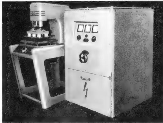
Bild 1. Frequenzstabiler Körting-Hf-Generator (2 kW) für dielektrische Erwärmung
